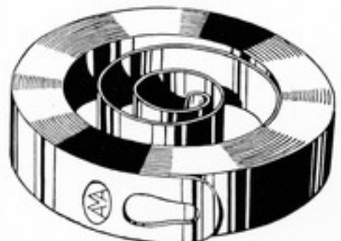
Zugfedern mit Loch aus feinstem schwedischen Uhrfederstahl
